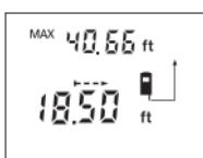
Si se oprime el botón de medición **10**, se interrumpirá la medición. El valor medido actual se indicara en la pantalla.
