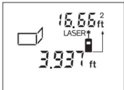
Después, mida la longitud **B<sub>1</sub>** de la primera pared. La superficie se calcula e indica automáticamente. El último valor de medición de la longitud se indica en la parte inferior de la pantalla, mientras que la superficie se indica en la parte superior. El láser permanece encendido.
