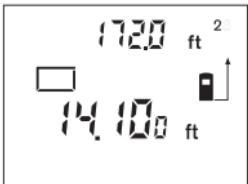
Después, mida la longitud y la anchura, una después de otra, de la misma manera que para realizar una medición de longitud. El rayo láser permanecerá encendido entre ambas mediciones.
